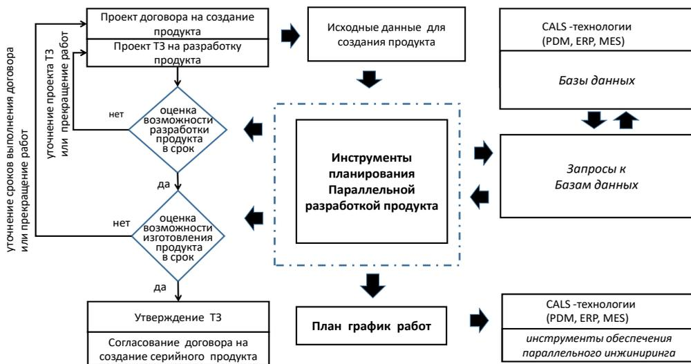
Рис. 1. Схема применения разрабатываемых инструментов планирования
