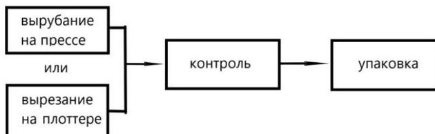
**Рис.1.** Производственный процесс изготовления прокладок «00» исполнения
